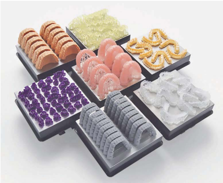
Рис. 1. Приклади полімерних деталей зубів, виготовлених на 3D-принтері
